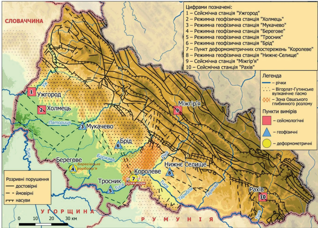
Рис. 1. Геофізичні спостереження на території Карпатського геодинамічного полігону, мережа геофізичних та сейсмологічних станцій Відділу сейсмічності Карпатського регіону Інституту геофізики ім. С. І. Субботіна НАН України; геологічні структури Закарпатського внутрішнього прогину; розташування пунктів спостереження параметрів геофізичних полів в регіоні.
