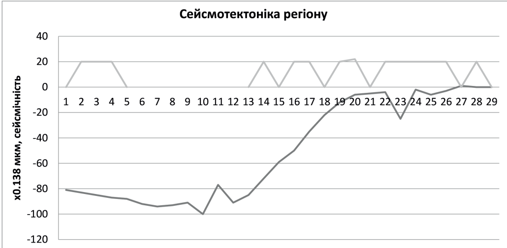
Рис. 3. Сейсмічність регіону (діаграма сірого кольору), сучасні рухи кори (крива чорного кольору). Закарпатський внутрішній прогин, лютий 2021 року.
