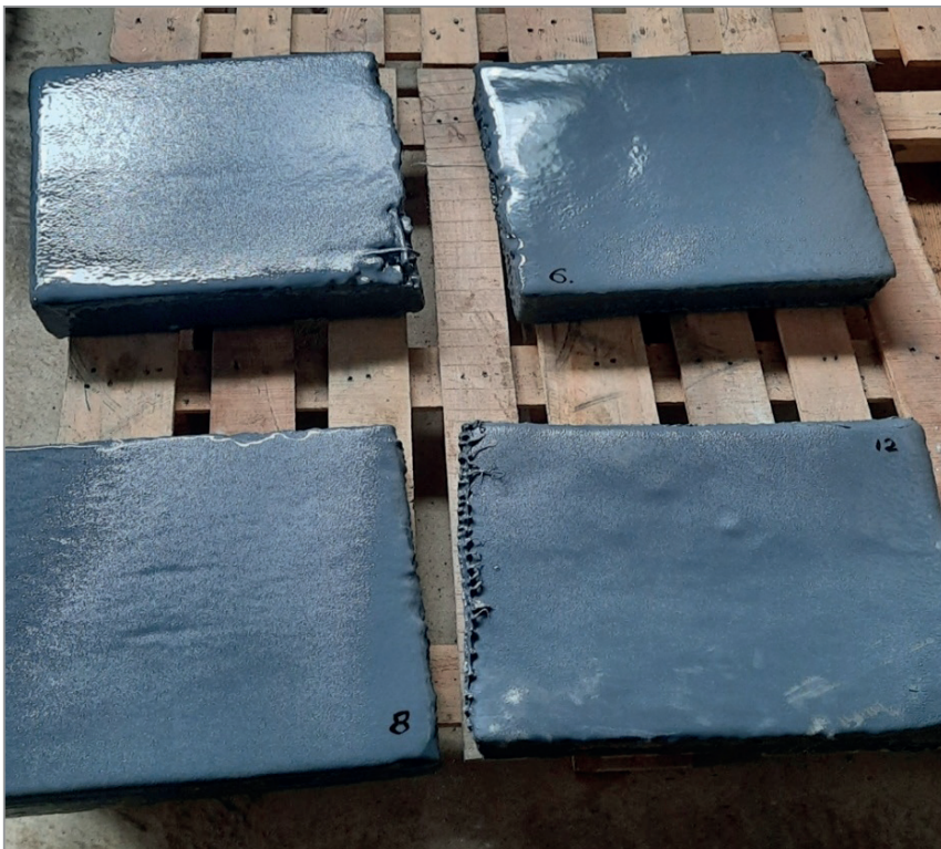
Рис. 6. Залізобетонні плити з нанесеним протиуламковим покриттям.
